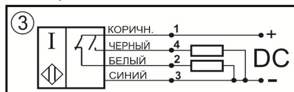
Схема подключения Переключающий контакт
